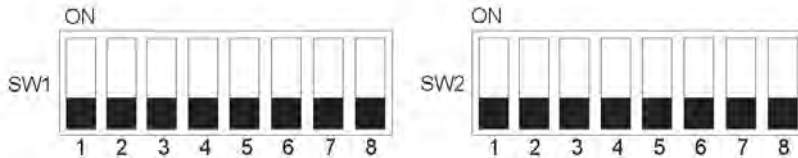
Abbildung 18: DIP-Schalter Standardeinstellung Reset-Einstellung
