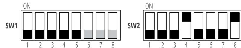
Abbildung 88: Zusätzliche Funkreedkontakte anlernen
