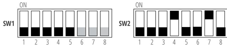
Abbildung 89: Zusätzliche Funkrelaismodule anlernen
