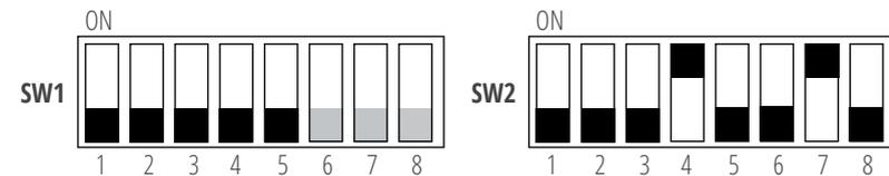
Abbildung 57: Zusätzliche Funkrelaismodule anlernen
