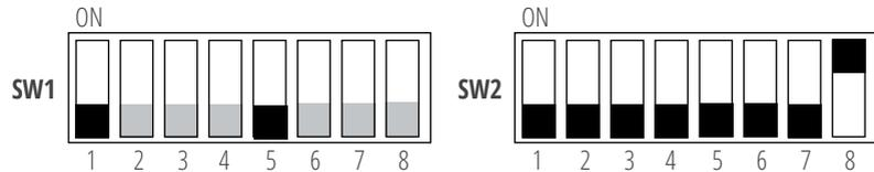
Abbildung 44: Einstellung des Relaisverhaltens; Relais 1 und Relais 2
