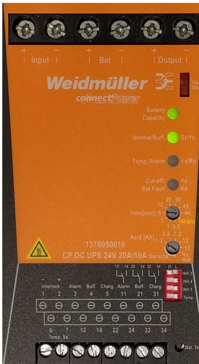
Abbildung 4.5: LED Anzeigen an der USV
