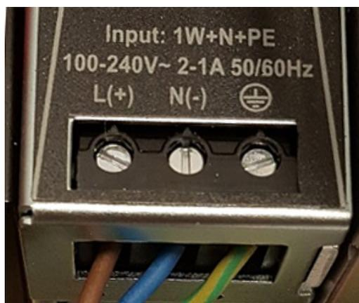
Abbildung 4.3: Anschluss der 230V Versorgung
