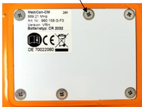
Abb. 1: Batterieabdeckung mit 6 St. Kreuzschlitzschrauben
