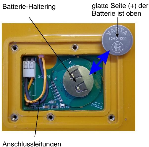
Abb. 2: Funkmodul mit Batterie, Typ CR2032
