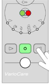
Der Sensor schaltet automatisch 10 Sekunden in den **Voralarm Pflege** und anschließend in den **Betriebsmodus**.
