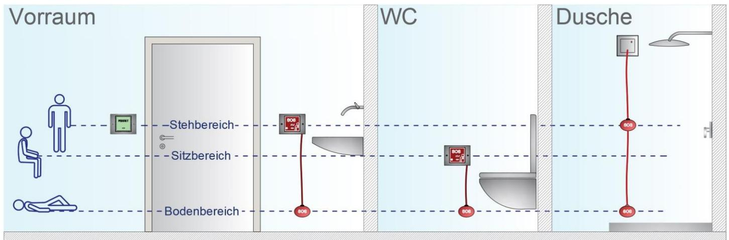
Alle Taster sind entsprechend Forderung DIN 18040 Teil 1 und Teil 3 mit Braille- und erhabener Profilschrift gekennzeichnet.
