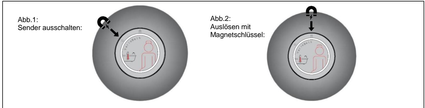
Bild 2: Sender einschalten / auslösen mit Magnetschlüssel (Schlüssel-Positionierung gem. Inlay-Kennzeichnung beachten)
