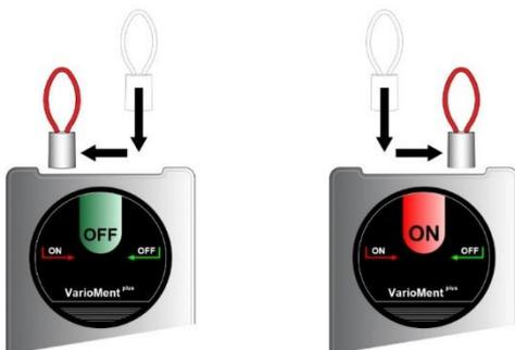
Die Pflegekraft kann über einen Magnetschlüssel die Tür ständig oder temporär freigeben, so dass diese ohne Rufauslösung geöffnet werden kann.
